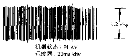
图 4-95 TP2055 和 TP2056 的波形
